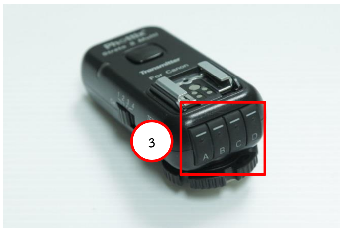
ภาพที่ 4-85 การตั้งค่าเครื่องส่งสัญญาณวิทยุกลุ่ม A
