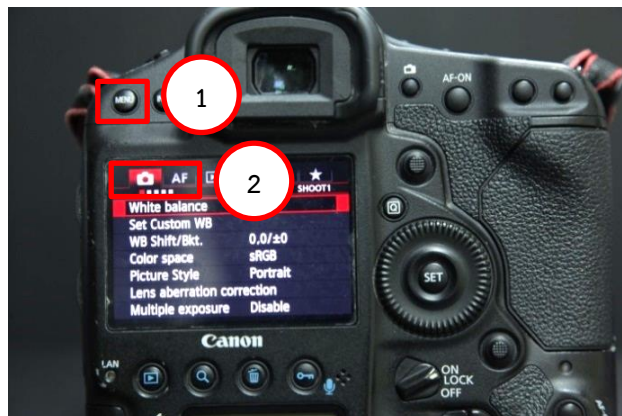
ภาพที่ 4-72 แสดงภาพปุ่ม Menu และ แท็บ Shoot 1
