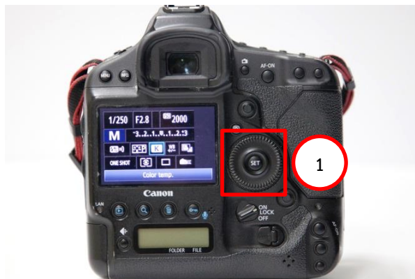
ภาพที่ 4-63 วงล้อปรับตั้งค่าด้านหลังกล้อง
